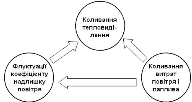
Рис.3. Механізм акустичних коливань при вібраційному горінні в КЗ ГТУ
