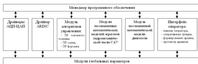
Рис.2. Структура программной части комплекса
