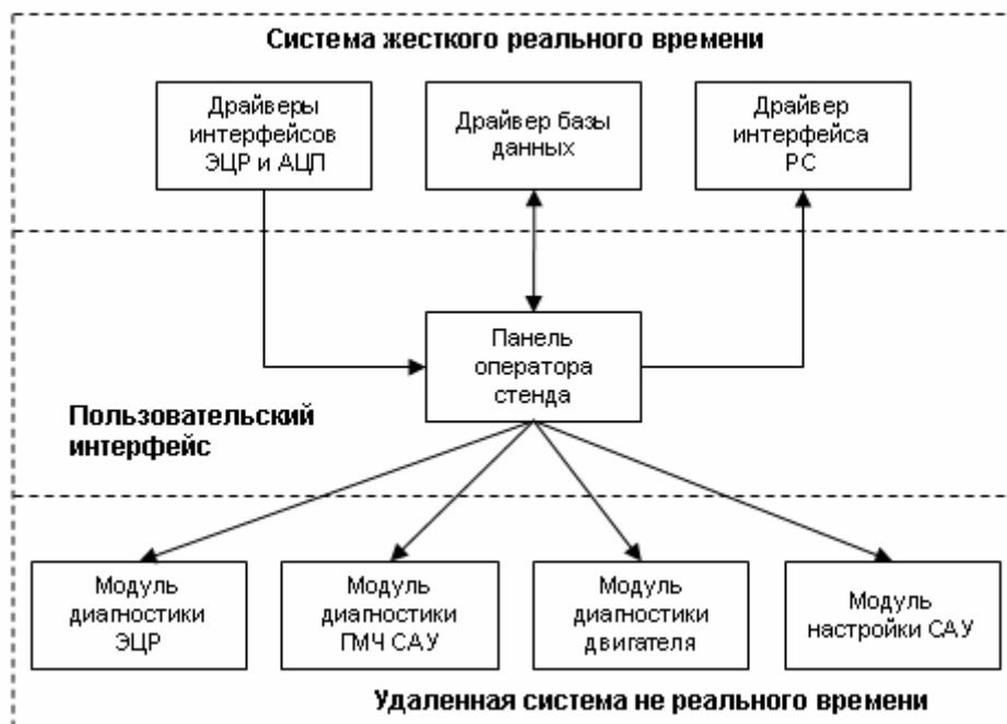
Рис.2. Структура программно-алгоритмического обеспечения интеллектуального испытательного стенда КАИ-25Ф
